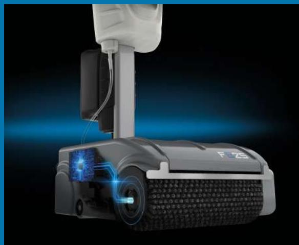
Autre nouveauté importante est le **Circuit Protector System (CPS)**, qui dans le cas d'effort excessif ou obstacles, il intervient sur la fiche électrique pour réduire la puissance. Dans cette manière on évite ruptures ou efforts excessifs sur la transmission.
